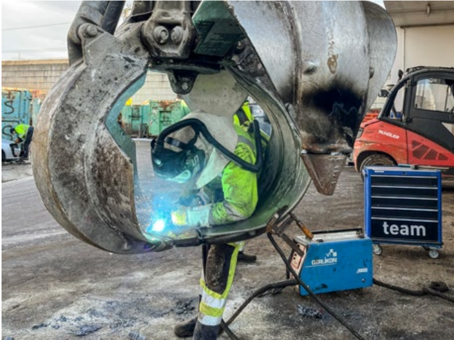
Moritz Dieterle brennt die alten Zähne am Greifer ab und schweißt neue auf.
